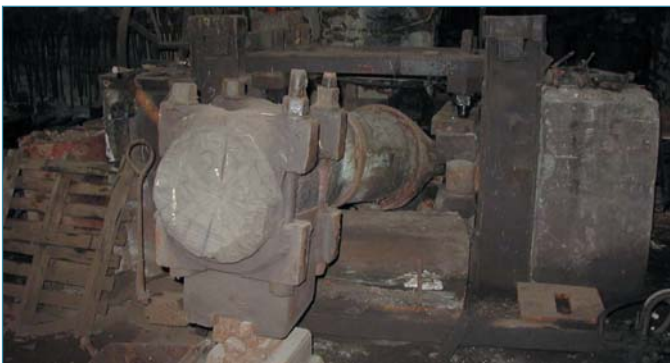
Figura 1 - Antico maglio idraulico dell'800.
