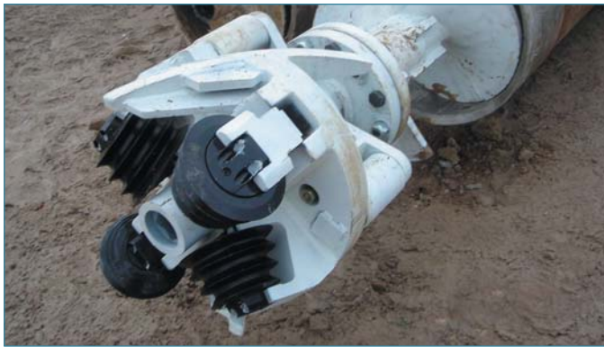
Figura 4 - Pal-Head. Testa di taglio per condotti rivestiti in tubo.
