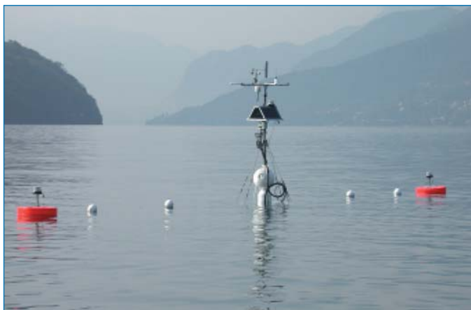
Figura 2 - Stazione LDS a compensazione di livello installata in prossimità del Comune di Gravedona. I dati delle tre stazioni LDS sono elaborati in tempo quasi reale e utilizzati come dati di input per il modello tridimensionale del Lago di Como.
