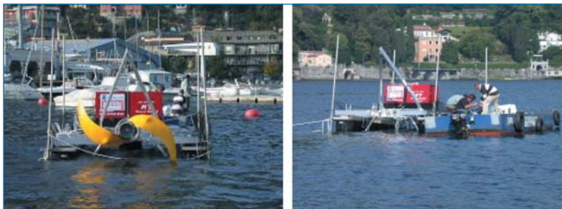
Figura 3 - Viste della zattera con dettaglio sul miscelatore ITT Flygt e sul gruppo elettrogeno.
