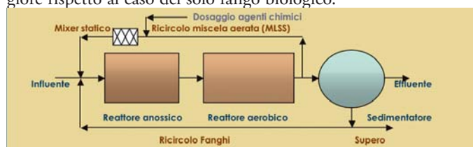
Figura 4 - Configurazione impiantistica per l’aggiunta, in linea, di reagenti per la rimozione di fosforo.
